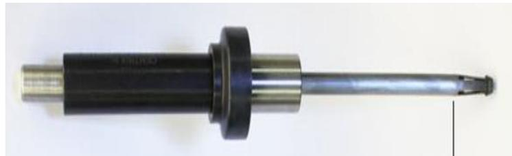
O Corpo Redondo: Este fixador é normalmente usado com cargas de fixação mais baixas. Tem um curso de 1 "a 1,5" (aderência máxima – aderência mínima). É normalmente usado em diâmetros de 0,437" e inferiores. Foi projetado para trabalhar com ferramentas padrão Cleco, já disponíveis no local de trabalho.
