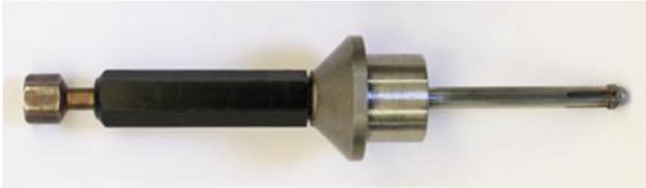
O Clamp Lok: Este fixador é frequentemente referido como super-cleco. Ele fornece altas cargas de fixação com um curso de 1" a 1,5" (aderência máxima – aderência mínima). Possui um perfil muito pequeno na parte traseira após a fixação. É normalmente usado em diâmetros de 0,25" e superiores
